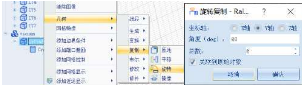
图 4-235 对 airX 进行旋转复制
